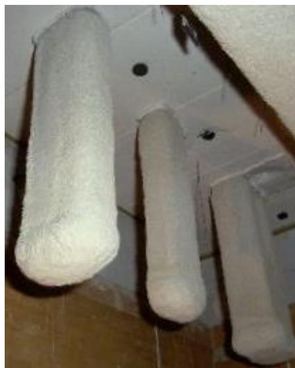
**Figura 8** - Fine della prova EN 13381-8 su elementi di acciaio tipo H
