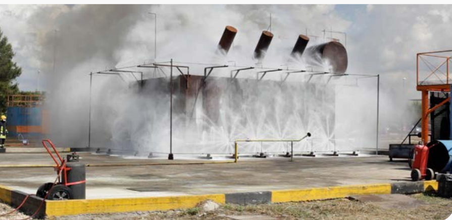
Test sperimentazione trasformatore elettrico – Spegnimento
