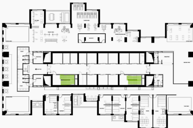
Figura 3 | La pianta del 16° piano del downtown one adibito a zona fitness. Evidenziati in verde i due vani scala. In un edificio a molti piani, le scale rappresentano tipicamente l'unica via di esodo percorribile dagli occupanti durante un incendio.
