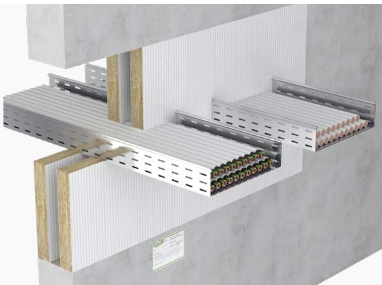
Figura 1 | Attraversamento elettrico eseguito tramite doppia pannellatura TECNOBOARD Marvon
