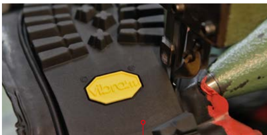
La fase di rifilatura.
