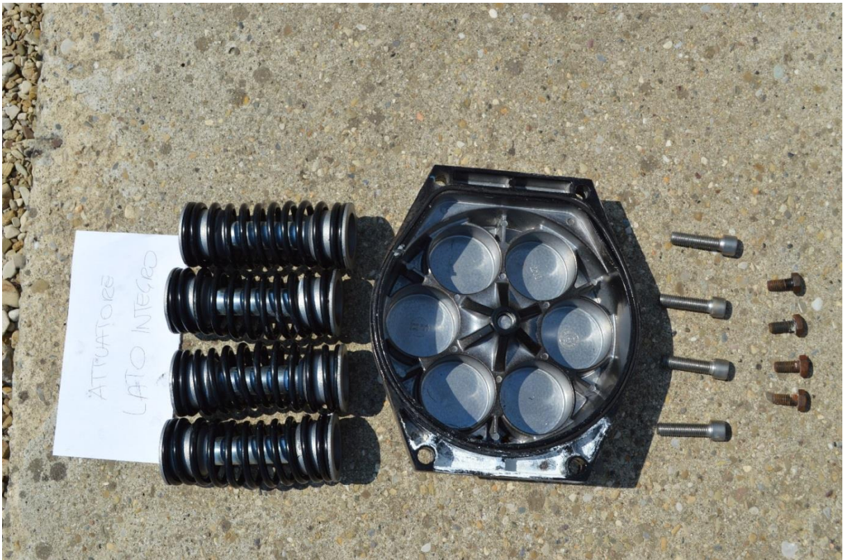
Figura 5: lato integro dell'attuatore. Si noti la sostanza di colore bianco nella parte in basso, che ha costituito un indizio importante per la ricerca delle cause
